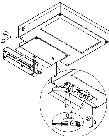
4. 将灯具卡入壁板后·锁紧螺丝。
