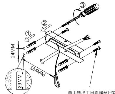
2.按图示尺寸·将壁盒后座锁到水泥上面。
