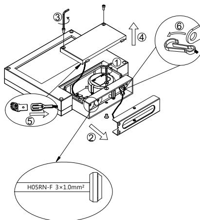
1. 断开电源·松开螺丝·取出灯具壁板。
