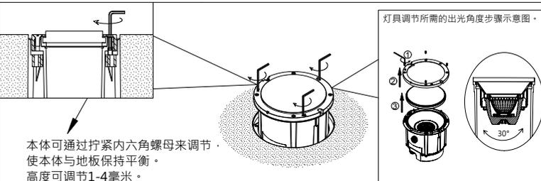
注意: 如需调节灯具角度·在锁定面板之前·请点亮灯具·让空气蒸发·然后再锁紧灯具面板。
