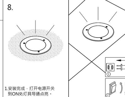
1. 安装完成·打开电源开关到ON处灯具导通点亮。
