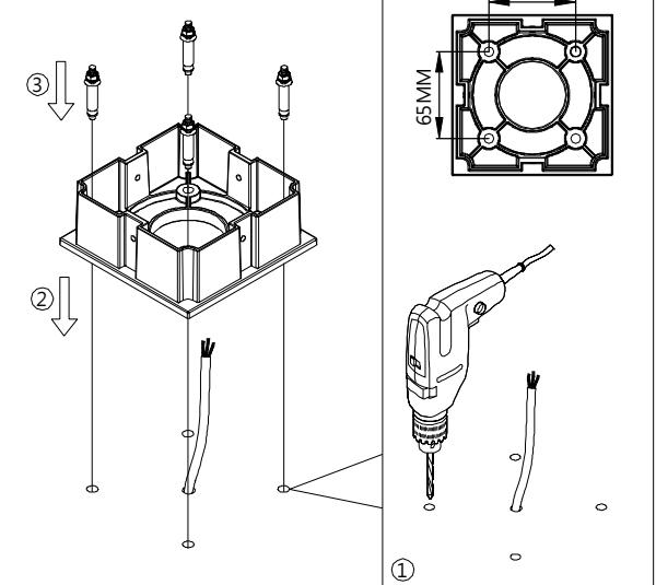
1. 断开电源·将壁盒后座从灯具底部取出。
