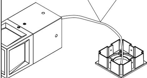
3. 将灯具出线连接外部电源。
