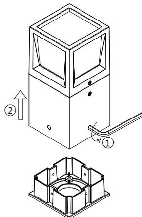
1. 断开电源·将壁盒后座从灯具底部取出。
