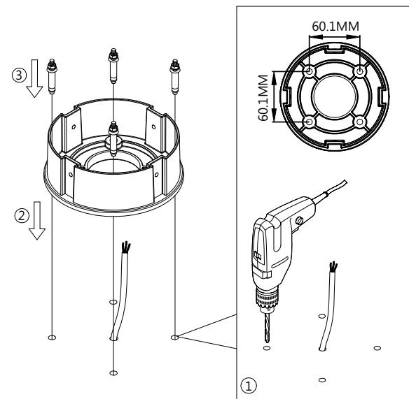
2. 按图示尺寸·将底座安装在安装面上。
