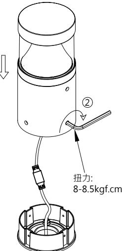
3. 将灯具出线连接外部电源。
