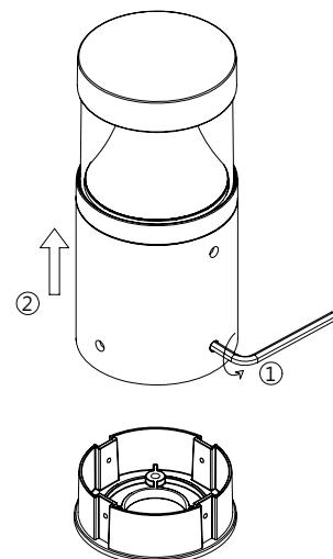
1. 断开电源·将壁盒后座从灯具底部取出。
