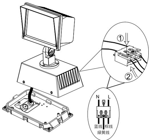
4. 将穿过防水塞的电缆线连接好灯具输入端子。
