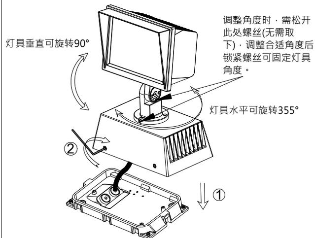
5. 将灯具装回壁板并锁紧螺丝, 调节好所需的照射角度。
