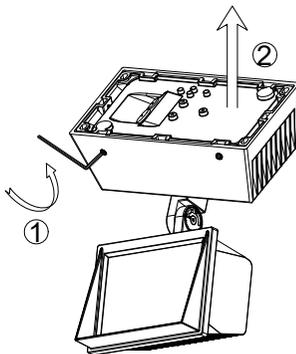
1. 断开电源, 用扳手将壁盒螺丝取下, 取出壁板。
