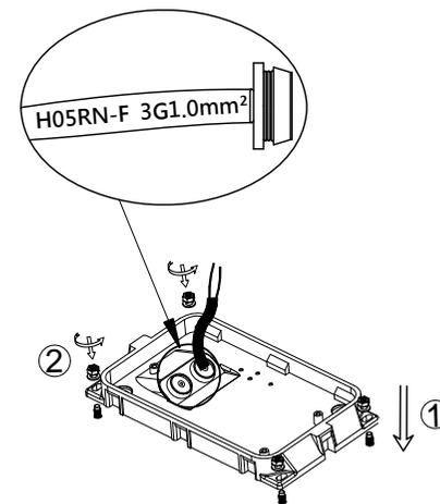
3. 将电缆线穿过壁板上的防水塞后, 对准螺丝孔位装入后用螺母锁紧壁板。
