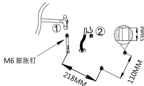
2. 选择合适的位置按照图面尺寸钻孔, 将M6 膨胀钉用铁锤打入孔内。
