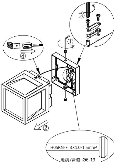
注:接入灯具线材需使用H05RN-F 3G1.0mm² 电缆线·穿线后再剥线·才能达到IP防护等级
